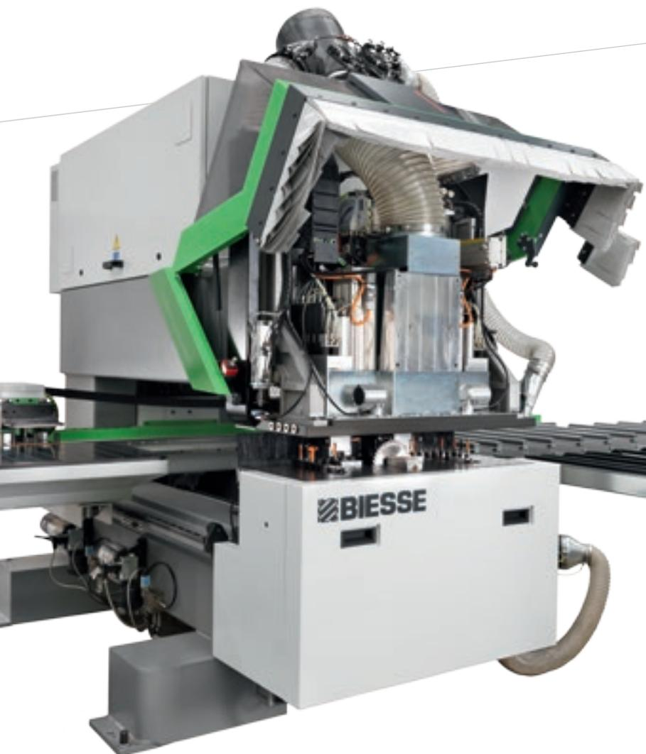
Le façonnage du bâti machine sur les centres d'usinage à positionnement unique garantit de très grandes précisions pour les façonnages mécaniques. Les unités d'usinage fixes (et panneaux mobiles) garantissent précision et fiabilité de façonnage au fil du temps.
